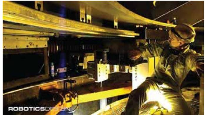
que forman un brazo serpiente unido a un eje vertical que se puede hacer móvil a lo largo de un carril, o estacionario cuando se fija a una columna utilizando nuestro sistema de soporte robusto. Su diseño modular e hiperredundancia le permiten transportar cargas de hasta 500kg y maniobrar alrededor de obstáculos, haciendo que el **ANATERGOARM**™ TMA-500 sea altamente efectivo para tareas en espacios de trabajo limitados.
